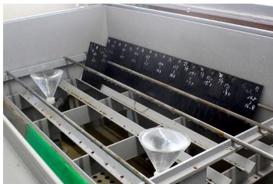
自動車業界のお客様がご希望するのは、耐食性（防錆力）です。特に自動車内部のエンジン部品や強度補強部材での錆は、人命に関わるために特に重要視されています。そのため当社では、24時間365日稼働する塩水噴霧試験装置を活用して、耐食性を保証した状態で製品を提供しております。また業界毎に定められる規格に合わせた塩水噴霧試験を行うことが出来ることはもちろんのこと、ご要望に応じて個別の製品への塩水噴霧試験も承っております。
